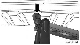
**Aligning Gate To Slots**
